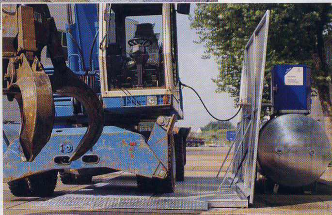
Tankstelle geschlossen: Die Spritzschutzwände schützen während der Betriebspausen die vier Auffangwannen vor Niederschlag.
